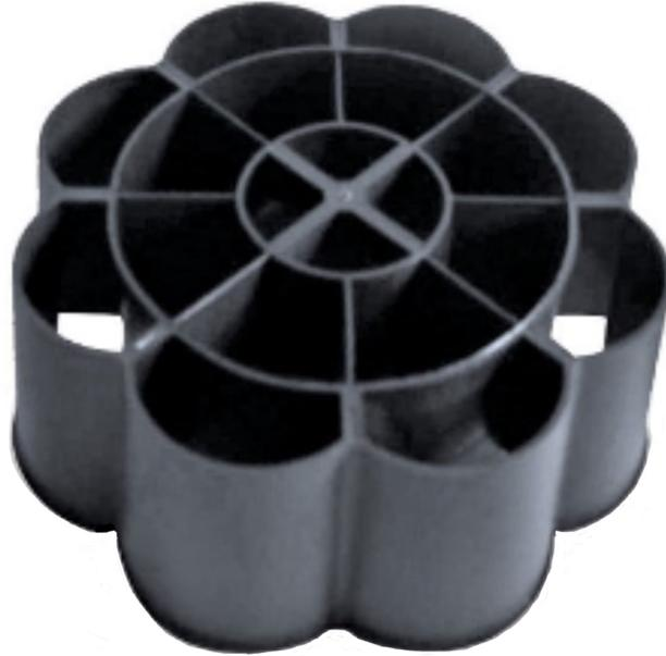
El relleno filtrante ha sido especialmente diseñado para tratar altas cargas hidráulicas, siendo habitual su desempeño en filtros percoladores. Su estructura de nervios centrales entre superficies cilíndricas le confiere gran resistencia a la compresión. Sometido a alturas de lecho de hasta 6 Mt.
